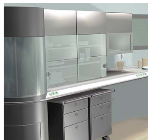
FOR KØRESTOLSBRUGER - Dette køkken er på ca. 12 kvm er beregnet til, at en kørestolsbruger skal kunne arbejde og komme bekvemt rundt. Der er nem adgang til opbevarede ting i skabe, der kan hæves og sænkes, samt fri benplads.
